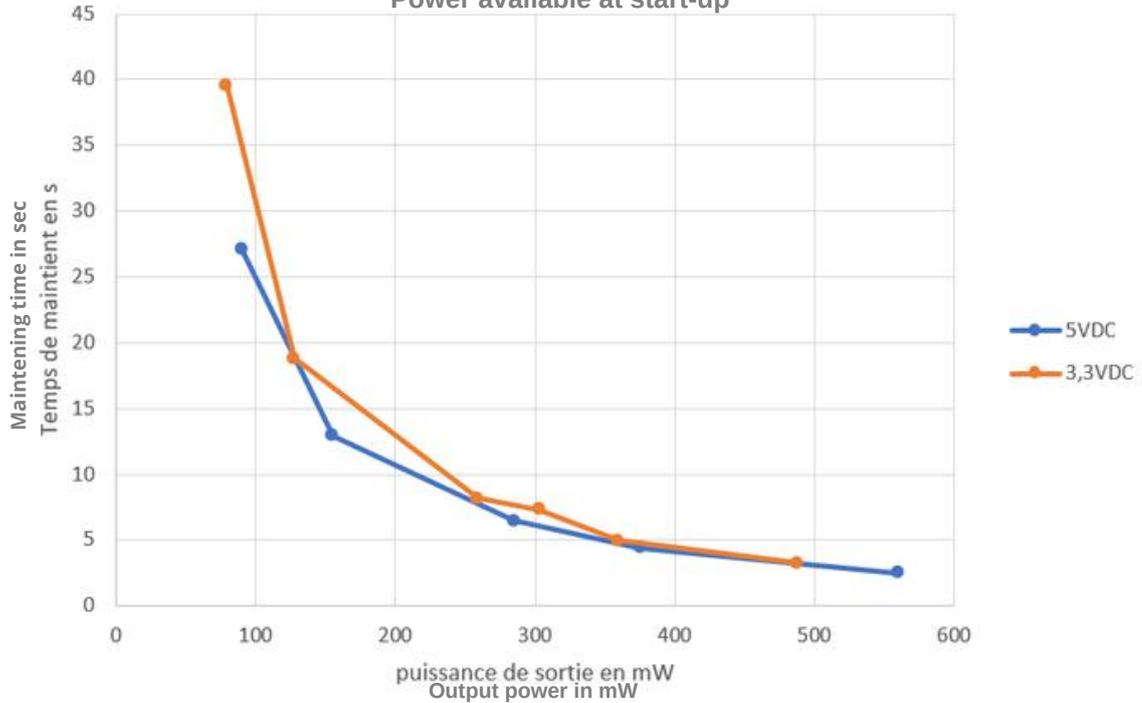
Capacité de courant au démarrage
